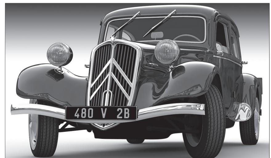
Citroën Traction Avant — один из первых в мире серийных переднеприводных автомобилей с несущим кузовом
